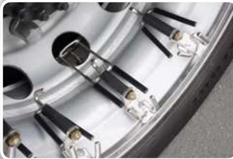
Dann drehen bis der Schutzbügel über dem Ventil des äußeren Rades liegt. Den Ventilschutz aufschieben bis dieser am inneren Felgenhorn anliegt und den Ring mittels der Spannmutter so spreizen, dass dieser mit ausreichendem Kraftschluß im Felgenhorn verspannt ist.
