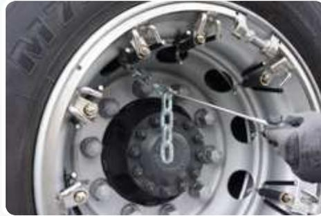
Die Kettenlänge ermitteln, die evtl. übrigen Kettenglieder am inneren Haken auslassen. Im unteren Bereich des Rades werden die Kettenstränge durch die Felgenlöcher von innen nach außen angelegt.
