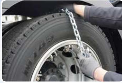
Die Kettenstränge werden einzeln über das Rad gelegt. Mit Hilfe des Hakens durch das Felgenloch ziehen und am inneren Spannhaken einhängen. Das andere Ende an einen der äußeren Haken einhängen.
