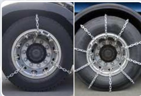
In der Mehrzahl der Einsätze reichen drei bis fünf Kettenstränge aus (als **Anfahrhilfe**). Bei Schneekettenpflicht sind jeweils alle Stränge zu montieren.
