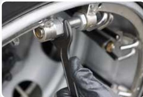
Die Spannmutter ist mit ca. 60 Nm anzuziehen und mit den Kontermuttern auf beiden Seiten zu sichern. Den Felgenreing nach ca. 100 km nochmals Nachspannen, dabei auf korrekten Sitz des Ringes (Ventilschutz) achten. Dieser Vorgang ist bei Bedarf zu wiederholen, da der Felgenreing sich erst an die Form des Felgenhorns anpasst.
